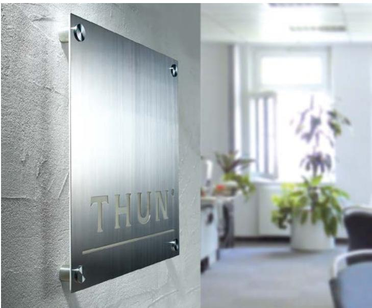
**IT** sistema di fissaggio in acciaio con chiusura laterale di sicurezza per piccoli formati. fissare il distanziatore alla parete, posizionare il pannello, inserire la testina nel foro e attraverso il pannello e completare il fissaggio tramite la brugola laterale di sicurezza, che impedisce che la targa possa venir manomessa o smontata. materiale: acciaio inox AISI304, testina con sfaccettature
