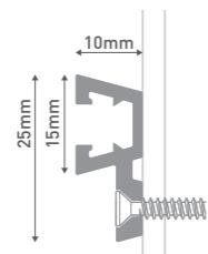
**IT.** binario in alluminio anodizzato per il fissaggio in colonna di molteplici targhe. l'altezza delle singole targhe può essere impostata e modificata facilmente grazie ai dadi in materiale plastico da inserire nel binario. soluzione perfetta per cambi frequenti. la parete viene forata solo per montare il binario.
