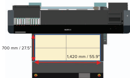
Max. média vastagság: 150 mm / 5,91" Max. média tömeg: 50 kg/m 2
